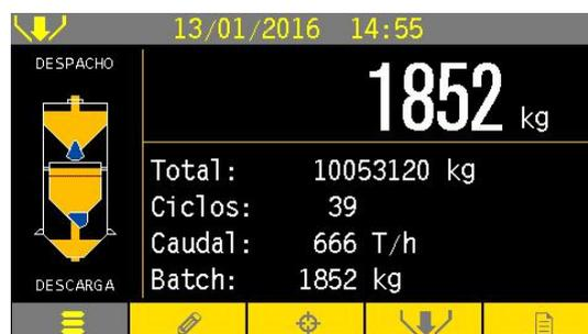
En caso de errores o alertas la información adicional es reemplazada por el mensaje del correspondiente error o alerta hasta que se presiones una tecla del equipo.
