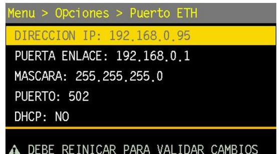
reinicie el equipo. Este menú se utiliza conjuntamente con el menú Puerto 6 Ethernet detallado en el apartado anterior.
