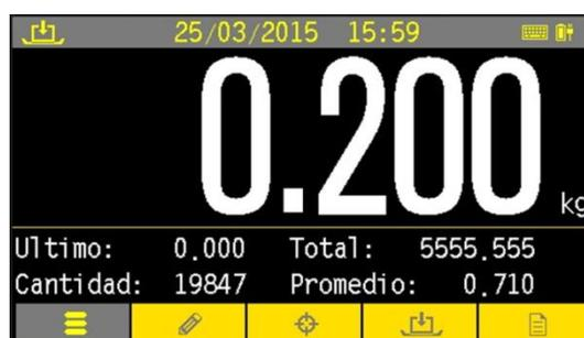
Durante el resto del proceso (registro y espera de descarga) se muestra el peso neto envasado, la aceptación del registro o el error correspondiente y la información completa en el área inferior.
