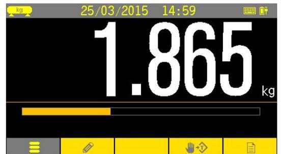
En modo neto el indicador de tara tomada esta prendido y la tara tomada se muestra (aunque esta sea cero) adicionalmente debajo de la barra de carga.
