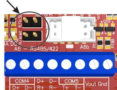
El puerto RS485 del indicador **ONIX** puede configurarse como terminal de línea colocando el jumper R. fin SL
