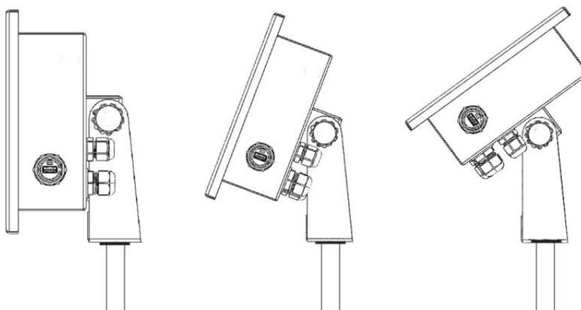
Montaje sobre columna – No se utiliza Base de pie
