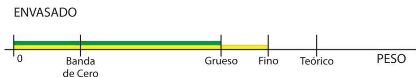
Luego el indicador activará la salida de **BOLSA LISTA** indicando que se puede retirar el recipiente y esperará a que el peso sea menor a la **banda de cero** programada para activar la salida **LISTO** momento en que se puede comenzar un nuevo ciclo.
