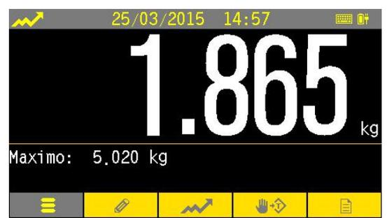
Adicionalmente se retiene el máximo peso alcanzado sobre la plataforma y se muestra en menor tamaño debajo del peso actual.
