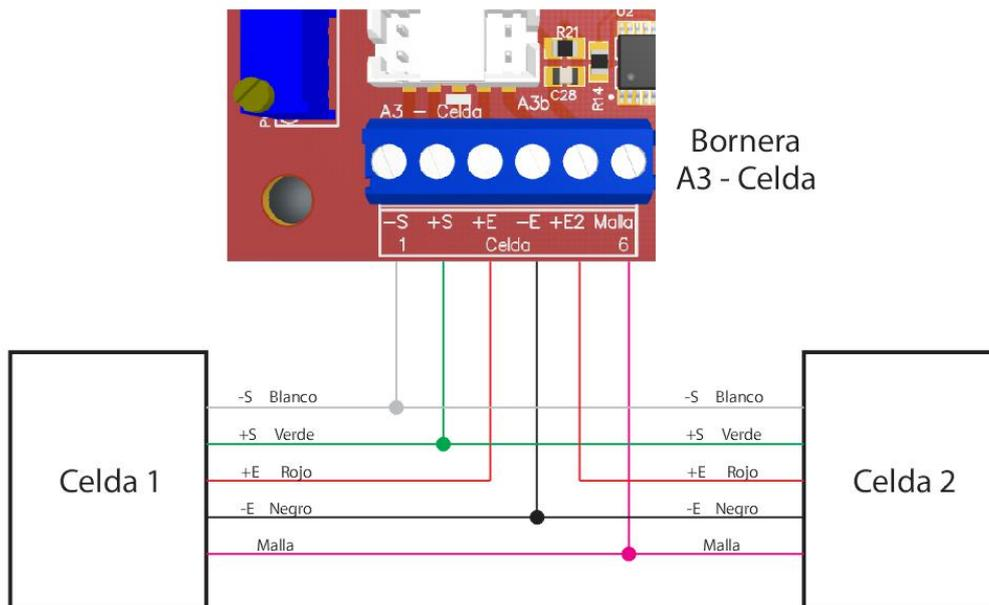
Se recomienda soldar los cables de ambas celdas entre si antes de introducir en la bornera.
